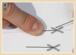
Die Andreaskreuze werden mit Sekundenkleber an Stahl- oder Messingdraht befestigt. Bitte den Kleber sparsam einsetzen. Damit Säule und Andreaskreuz gerade miteinander verbunden werden, wurde auf die Unterlage eine Hilfslinie gezeichnet.
