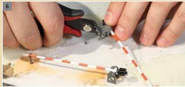
Die Zapfen, die bei Schrankenbock und –gabel zum Befestigen in der Grundplatte vorgesehen sind, werden hier nicht benötigt und müssen daher mit dem Seitenschneider entfernt werden.
