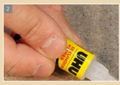
Jetzt werden die Feldbahngleise mit Sekundenkleber, der vorsichtig auf der Rückseite aufgetragen wird, befestigt. Es ist darauf zu achten, dass die Schienenstücke ohne Versatz aneinanderstoßen.
